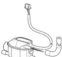
~ Установить вытяжную трубу на крышку детектора по направлению вверх.
